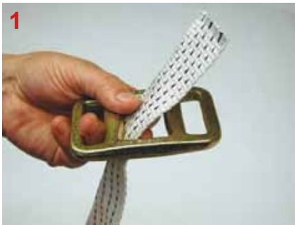
Bandende von unten durch die mittlere Öffnung schieben.
