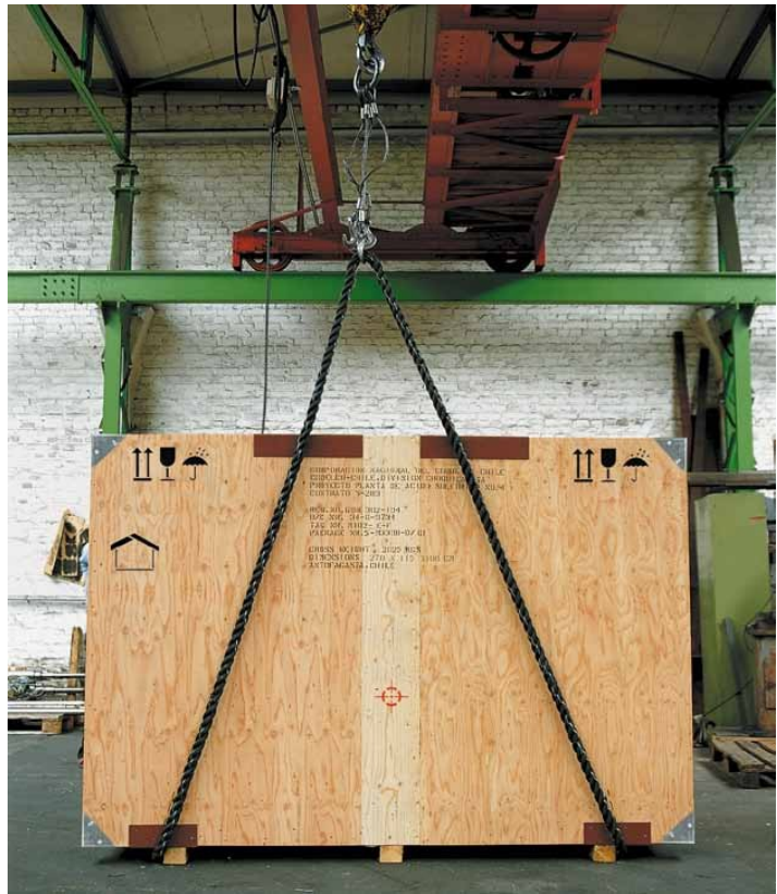
Exportkiste mit Kopfwinkeln, Deckelsicherungen und Eckenschonern
