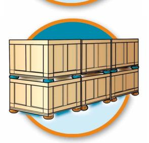
Die Montage der SKIDMATE® Dämpfungselemente erfolgt mit Flachrund- oder Sechskant-Schrauben Größe M8 (werden nicht mitgeliefert!).
