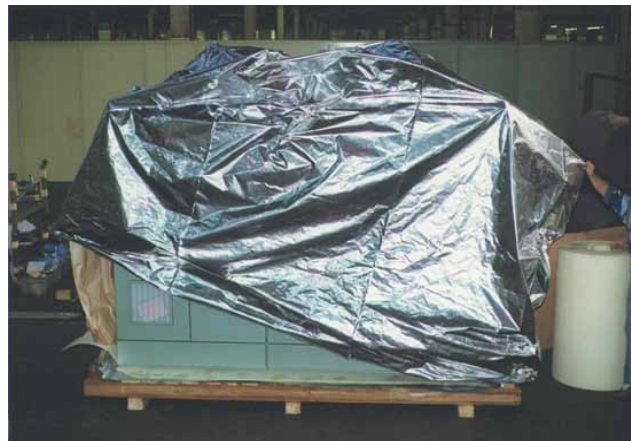
1. Maßgenaue Haube wird übergestreift.
