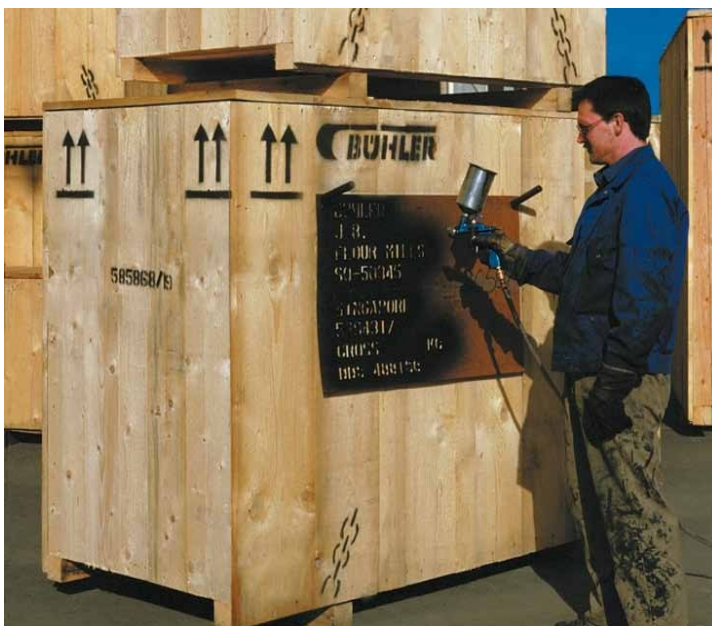
Signierung der Exportverpackung mit Spritzpistole.
