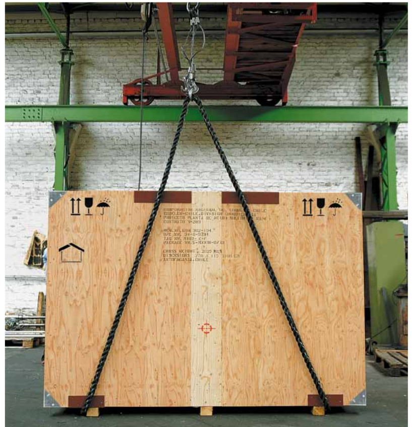
Exportkiste mit Kopfwinkeln, Deckelsicherungen und Eckenschonern
