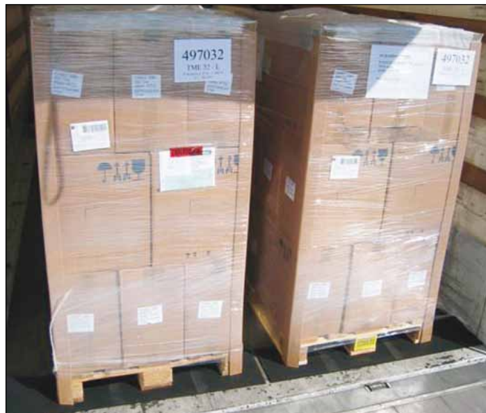
Anti-Rutsch-Matten bilden mit dem LKW oder Waggon eine unzertrennliche Einheit
