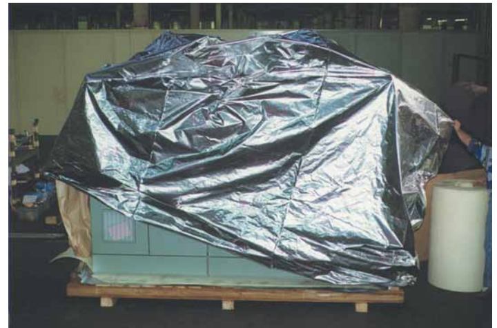
1. Maßgenaue Haube wird übergelegt.
