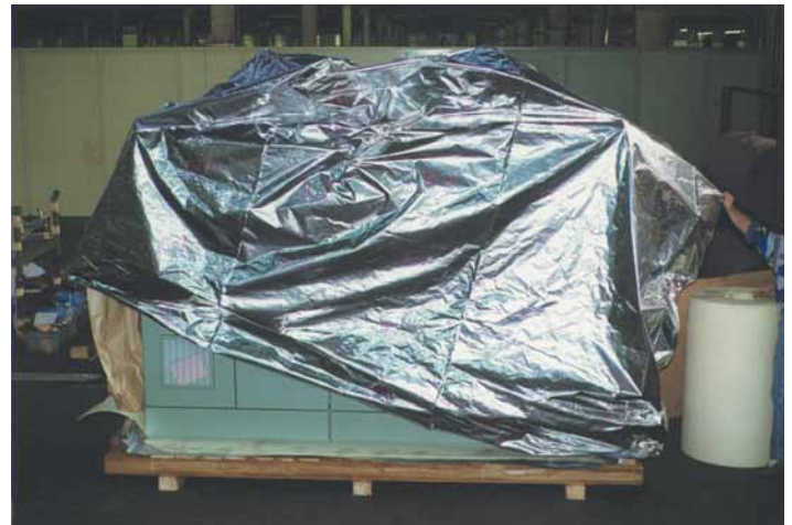
1. Maßgenaue Haube wird übergelegt.
