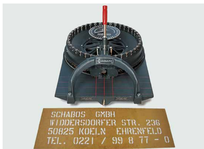
DIAGRAPH Stanzmaschinen, Type Jumbo Schrifthöhe 45 mm lateinisch, 45 mm kyrillisch auf Anfrage
